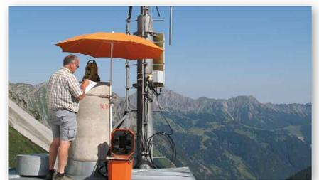
Am Ende der Satzmessung werden automatisch ein **vorläufiger Satzausgleich** berechnet und die maximalen Fehler und Verbesserungen angezeigt. So können die Ergebnisse bereits **im Feld überprüft** und – falls nötig – weitere Sätze zur Genauigkeitssteigerung gemessen werden.
