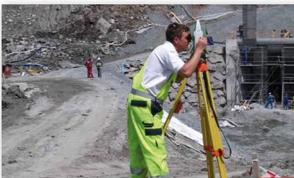
Mit dem Lernsatz werden die zu messenden Zielpunkte und ihre Reihenfolge festgelegt. Jedem Zielpunkt werden **individuell ATR-Status**, Prisma mit Additionskonstante, Zielhöhe, Lufttemperatur und Luftdruck zugeordnet. Optional können bekannte Zielpunkte nach Positionierung der Totalstation **automatisch angefahren** werden.
