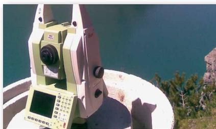
Die Zielpunkte werden in der im Lernsatz festgelegten Reihenfolge angefahren. Die zugeordneten Zielhöhen und Prismen werden dabei berücksichtigt. **Je nach ATR-Status** werden die Punkte **automatisch oder manuell** gemessen, nicht mehr messbare Zielpunkte können übersprungen werden.
